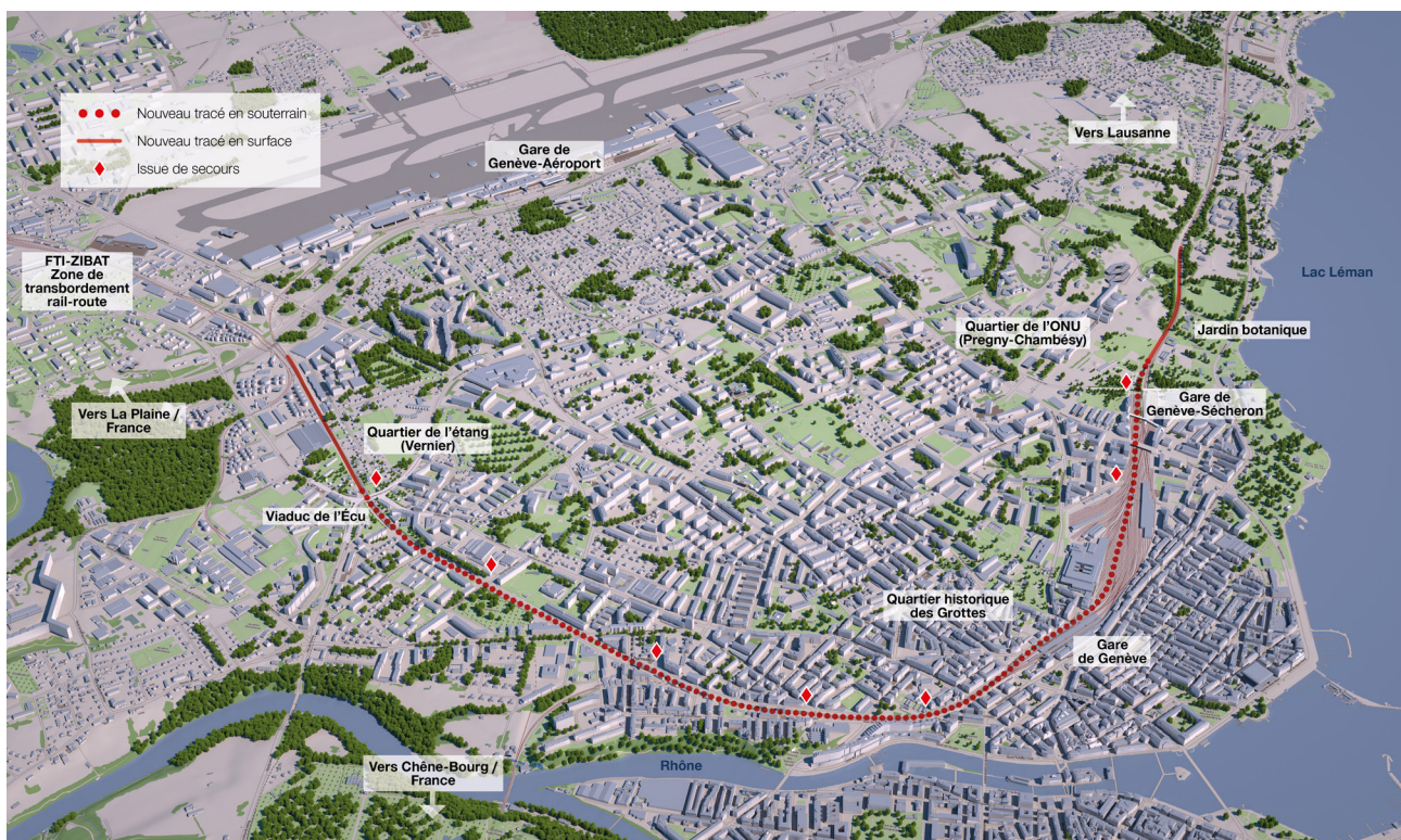
5 Image de synthèse montrant le futur tracé des tunnels qui raccordent le quai souterrain au réseau existant en surface et son intégration en milieu fortement urbain.
