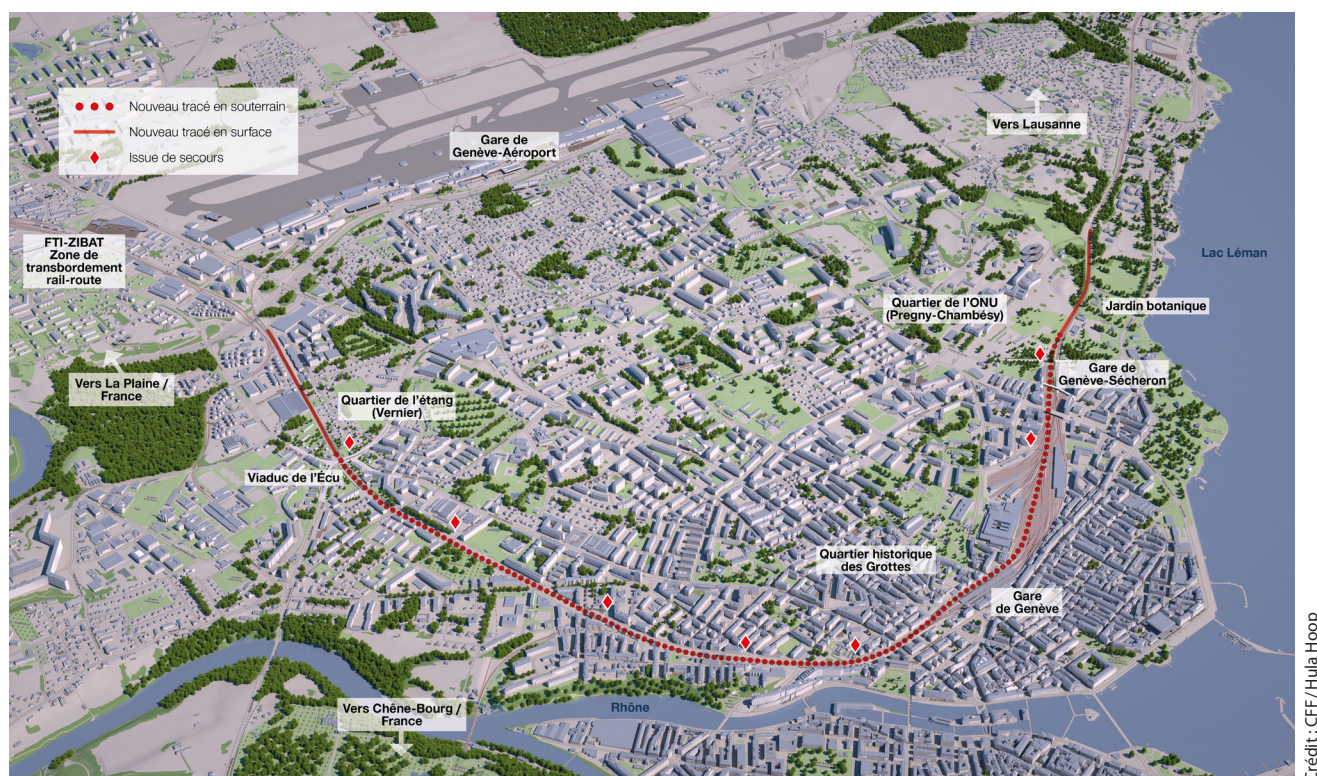
5 Image de synthèse montrant le futur tracé des tunnels qui relient le quai souterrain au réseau existant en surface et son intégration en milieu fortement urbain.
