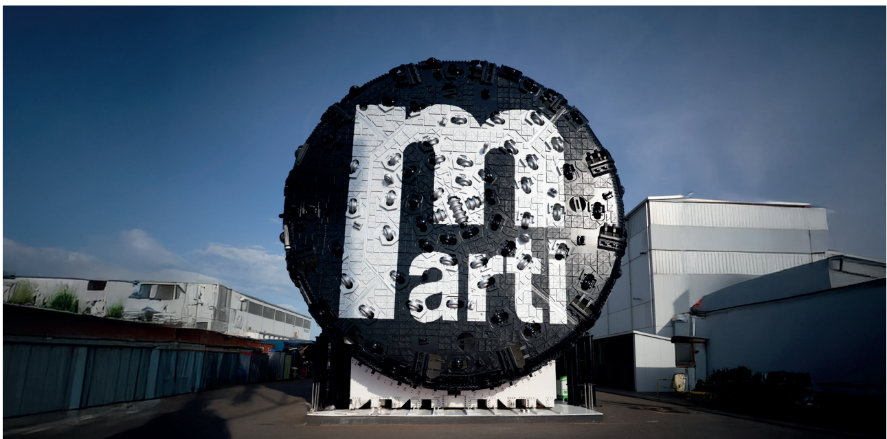
Tunnelbohrmaschine 2. Röhre Gotthard, Los 341
