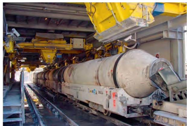
2 Betonzug beim Beladen unter der Betonanlage
