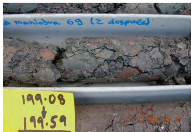
17 Bohrkerne aus der Brekzie mit Steineinlagen
