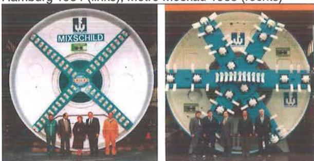
In Folge des Konstruktionsprinzips dieser Schneiräder ist der Einsatz von nach hinten ausbaubaren Schneidrollen kaum zu realisieren; dies gilt insbesondere bei kleinen bis mittleren Durchmessern.
