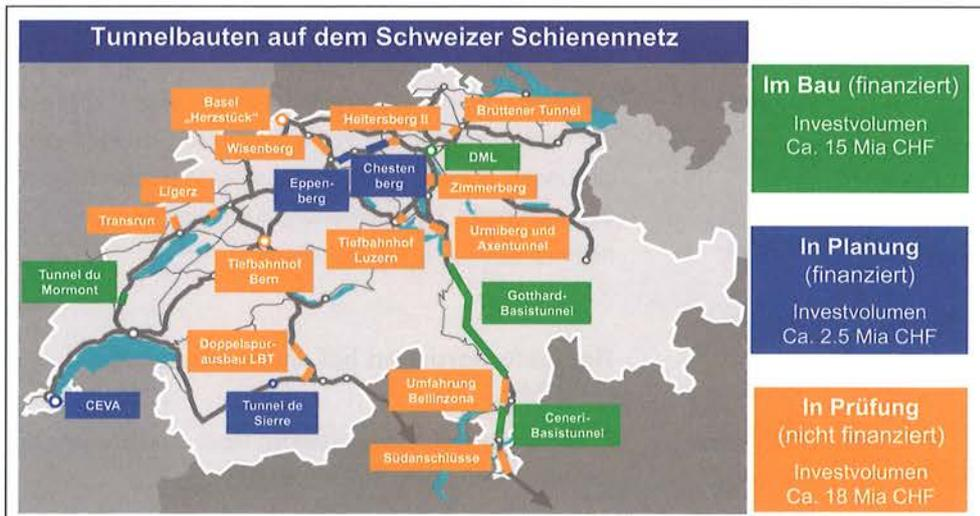
Bild 6: Bis 2020 erhöht sich die Gesamtlänge der Tunnels um 163 km oder +64% – weitere Projekte in Prüfung (Stand: Juni 2009)
