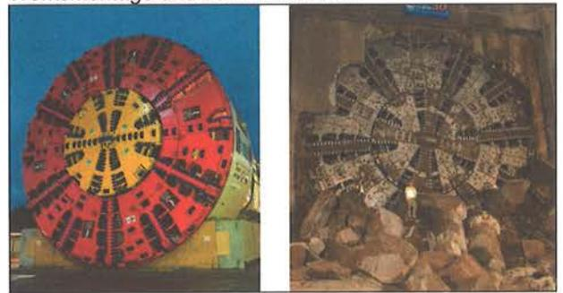
Das unabhängige Zentrumsschneidrad mit 7,0 m Durchmesser erlaubt eine höhere Geschwindigkeit der Werkzeuge und Mischdynamik im Zentrum dieser bisher grössten Erddruckmaschine. Als Zusatzeffekt wird auch eine teilweise Kompensation des Drehmoments erreicht, indem das innere und äussere Schneidrad in verschiedene Drehrichtungen betrieben werden können.
