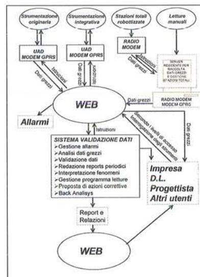
Foto 20: Schema funzionamento HI-CAP
