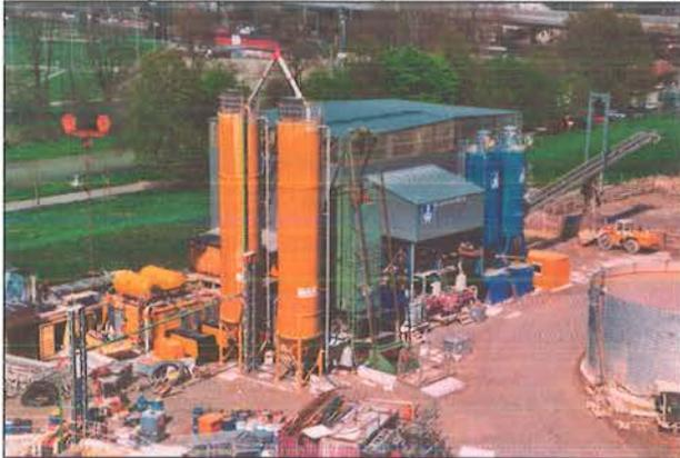
Bild 5: Separieranlage in Containerbauweise (PTS-Tunnel)
