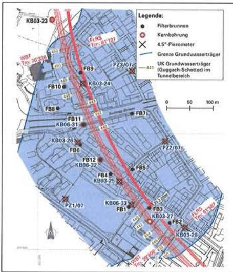
Bild 12: Grundwasserabsenkung Felsdepression Buchegg
