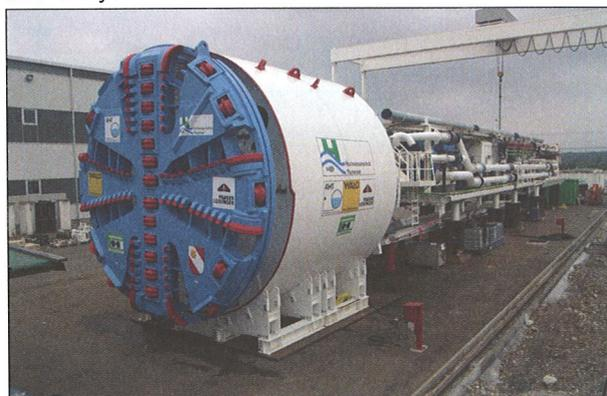
Zur Verhinderung des Einbrechens der Ortsbrust und damit grösserer Setzungen an der Oberfläche war der Abbauraum des Hydroschilds mit einer Stützflüssigkeit gefüllt. Der über ein Druckluftpolster regulierbare Stützdruck lag je nach Überdeckung, Grundwasserspiegel, Über-
