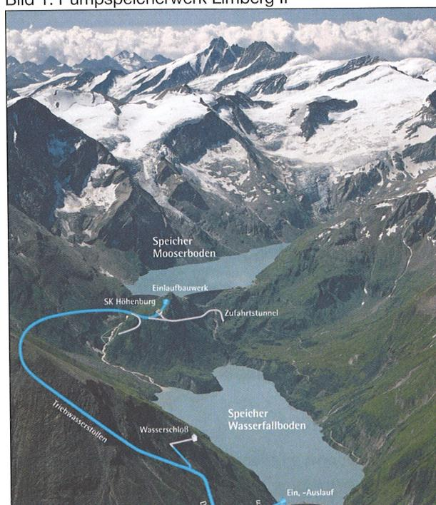
Das neue Pumpspeicherwerk Limberg II wird komplett unterirdisch errichtet, die Ausbauleistung wurde mit 480 MW festgelegt.
