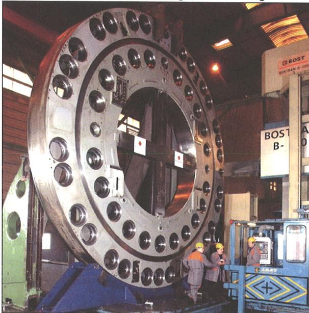
Um eine einwandfreie Funktion der Vortriebsanlage zu gewährleisten und um die neuen realisierten technischen Lösungen zu erproben wurde die Vortriebsanlage vollständig im Werk Schwanau montiert und umfangreichen Testläufen unterzogen. Um den Aufwand für Demontage, Transport sowie Baustellenmontage auf ein Mindestmass zu reduzieren wurde die komplette Anlage in Modulbauweise realisiert. Durch diese Massnahmen konnte die Werksabnahme bereits 12 Monate nach Auftragseingang in Schwanau erfolgen.
