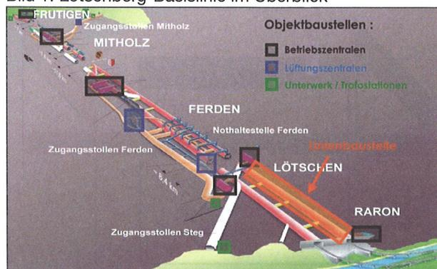
Die Lötschberg-Basislinie führt von Frutigen im Berner Oberland nach Raron im Kanton Wallis, wo der Anschluss an die SBB-Linie erfolgt. Sie umfasst den Anschluss und die Umfahrung Frutigen mit dem Tunnel Englistigen (Transittunnel), den Lötschberg Basistunnel sowie die Rhonequerung bei Raron.
