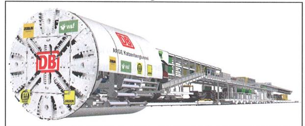
Im weiteren ist der Bohrkopf für die Konditionierung des Abbaumaterials mit 8 Schaumkanälen ausgerüstet.
