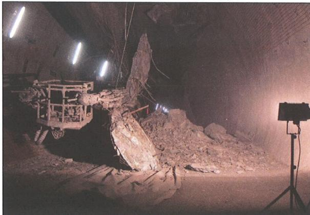
Bild 29: Bergschlagschäden
