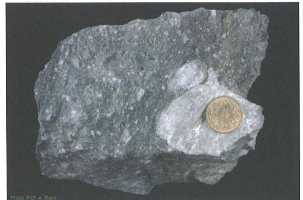
Bild 7: Kakirit aus dem Niederbruch TM 2'721 Querkaverne mit angerundeten Gesteinsbruchstücken unterschiedlicher Grösse in grauem siltig-tonigem Gesteinsmehl (fault gouge). Foto Prof. A. Steck
