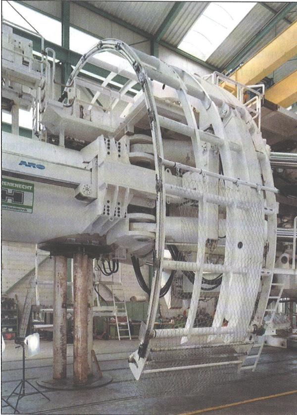
Bild 6: Verzahnter Ring der Versetzvorrichtung
