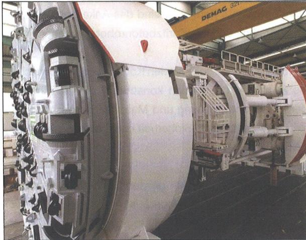
Standardwerkzeug bei grossen TBM ist heute die 17"-Diskenrolle mit einer möglichen Meisselbelastung von 267 kN. Grössere Bohrwerkzeuge, wie in der Vergangenheit verschiedentlich vorgeschlagen, haben sich auf Grund des hohen Gewichts als unhandlich beim Meisselwechsel erwiesen.
