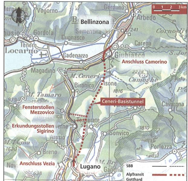
Der Ceneri-Basistunnel wird vom Zwischenangriff Sigrino gleichzeitig Richtung Norden und Süden vorgetrieben. Die Vorbereitungsarbeiten haben im Januar 1997 begonnen. Bereits wurde ein über 3 km langer Sondierstollen ausgebrochen. Die Erkenntnisse aus diesen Arbeiten werden direkt für die Projektierung des künftigen Ceneri-Basistunnels verwendet.
