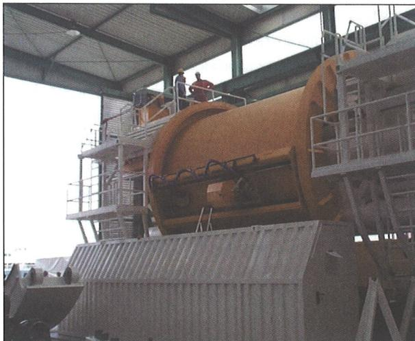
Der Übergabebereich zwischen NL und TBM ist grosszügig gestaltet, um einen ungehinderten Materialfluss zu gewährleisten. Auf dem NL 1 sind das Ankerbohrgerät, die Arbeitsbühne und der Spritzbetonroboter montiert.
