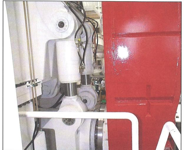
Aufgrund der statischen Bestimmtheit des Systems während des Verspannens durch die Gripperschuhe und dem Auflagerpunkt des Sohlschuhs am Bohrkopf kann die TBM während des Bohrprozesses über die horizontal und vertikal wirkenden Lenkzylinder (s. Bild 7) gesteuert werden. In Kombination mit einer schnellen Umsetzzeit erhöht sich somit die zur Verfügung stehende Bohrzeit.
