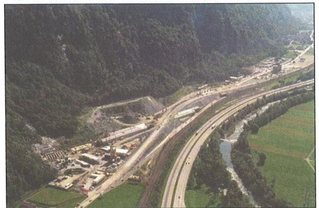
Fast die ganze, rund 400 m lange Tagbaustrecke des Basistunnels ist im Rohbau erstellt. Auf Grund der Gleislage ausserhalb des Basistunnels ist diese Strecke zuerst als Zwillingsröhre ausgebildet, die sich dann laufend verbreitert und schliesslich aus zwei nebeneinander liegenden eingedeckten Einzelröhren besteht.
