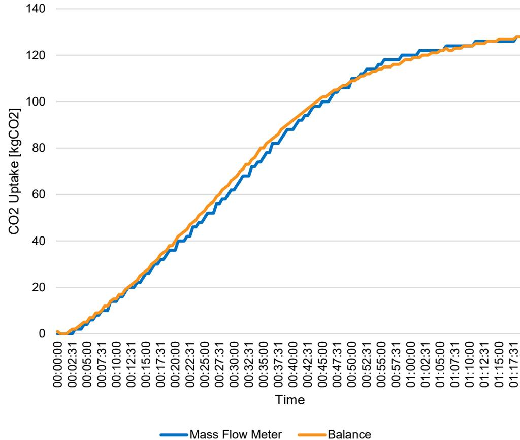
Innerhalb der **ersten 2,5h** können im Abbruchmaterial **80%** seiner **CO<sub>2</sub>-Aufnahmekapazität** erreicht werden.
